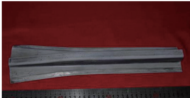
图13 脉冲电流辅助热拉深成形的零件
